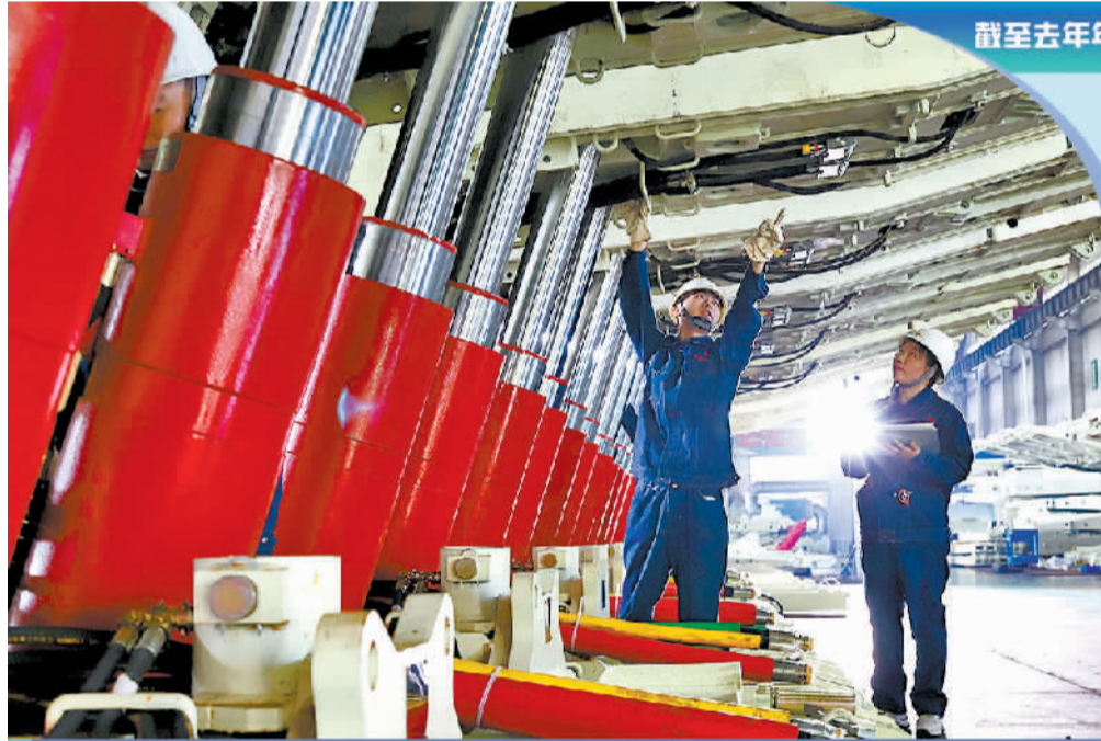
四川嘉华机械有限责任公司生产车间,用于急倾斜、大倾角煤层开采的智能综合采煤装备整齐排列。(资料图片)
