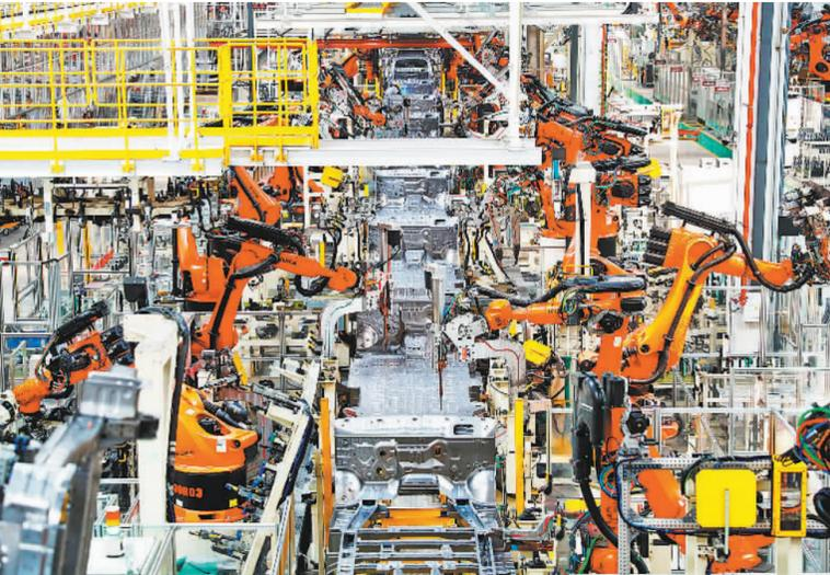
8月17日,位于山东莱西的北京汽车制造厂青岛总部基地生产车间,机械手在进行新能源汽车焊接作业。近年来,莱西市重点打造新能源汽车产业链,初步形成以整车制造为主导、关键零部件联动发展的产业体系。
