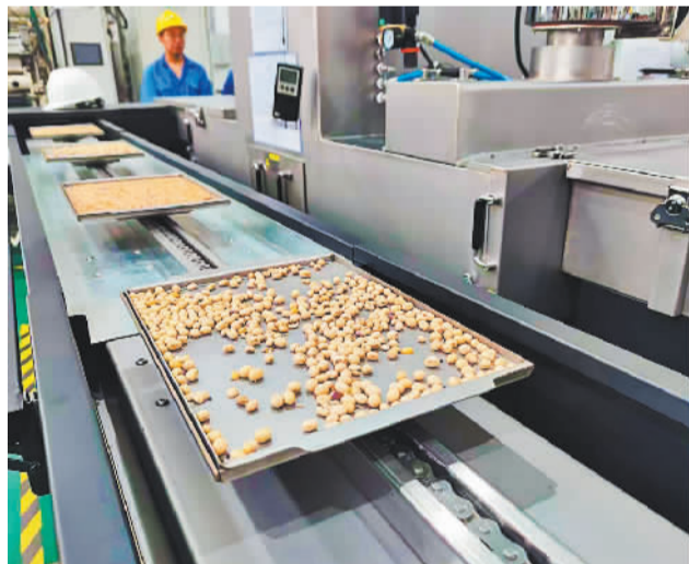
图为农作物品种通过自主研发的一机双束EB育种机进行辐照育种。 过国忠摄(中经视觉)
