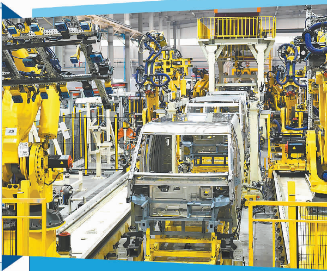
在山东省邹平市魏桥轻量化基地全铝车身集成生产线,机器人在铆接全铝小物流车身。
