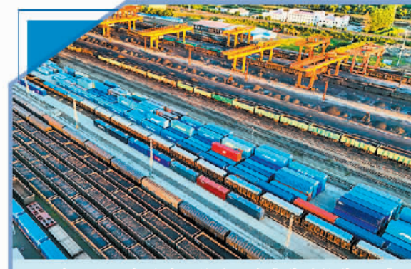
在黑龙江省绥芬河铁路口岸集装箱换装场，集装箱专用龙门吊对中欧班列进行集装箱换装作业。新华社记者 王松摄
