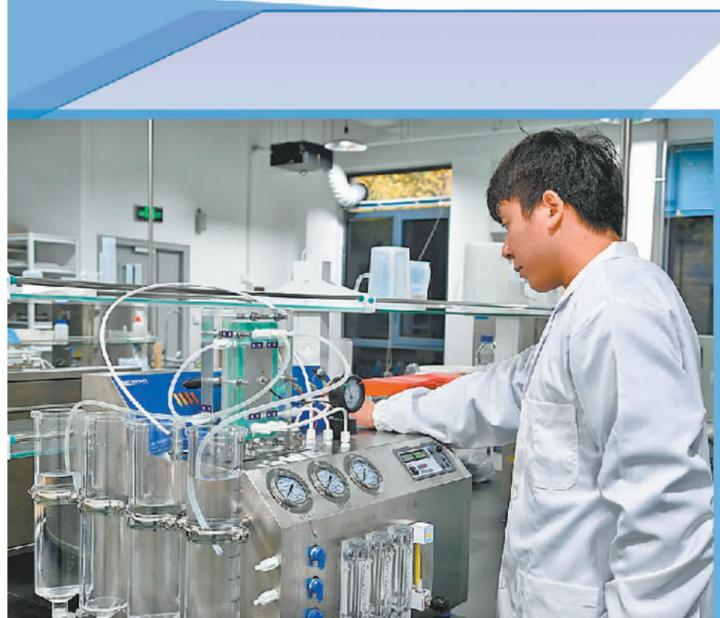
在博纳科技公司实验室,技术人员正在进行电渗析脱盐实验。
