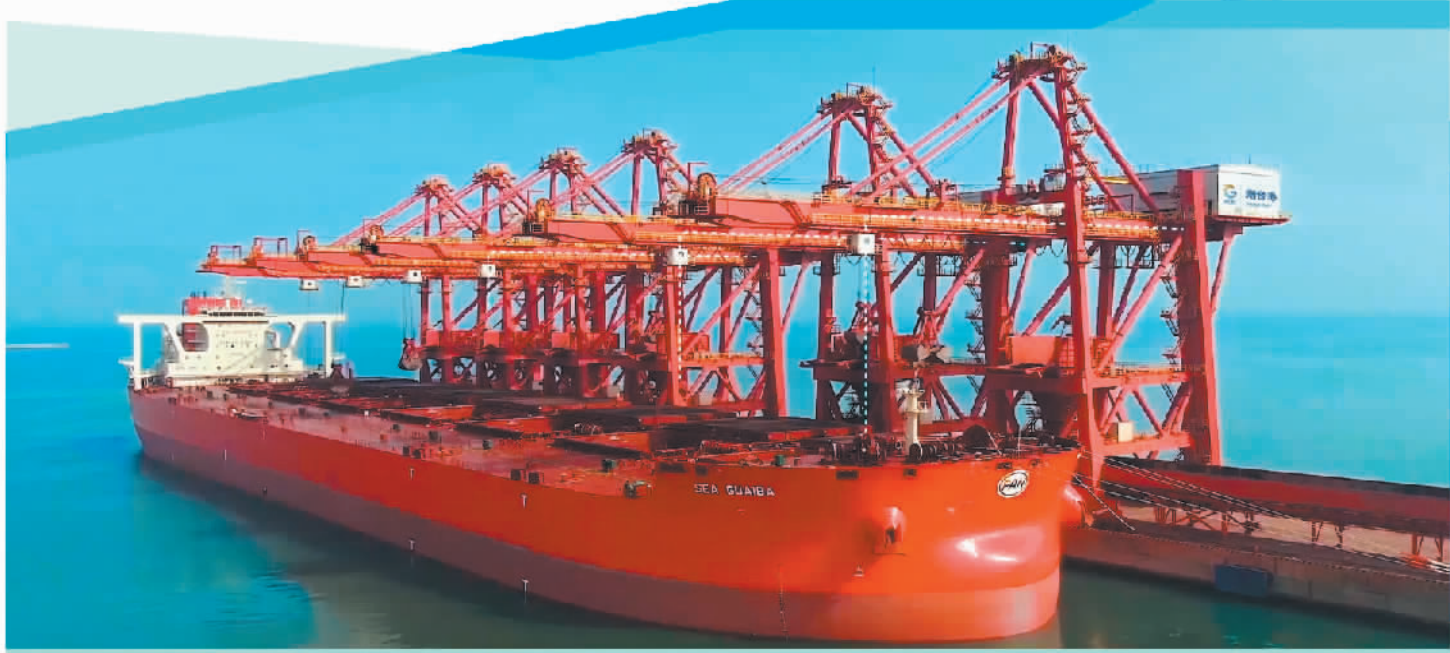
朝辉公司改造的卸船机在烟台港矿石码头进行自动化作业。
