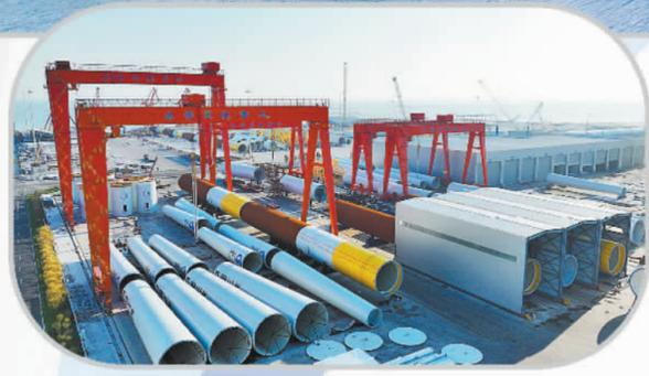
东营天能重工有限公司生产的塔筒正在等待运输至风电设备专用码头堆场
