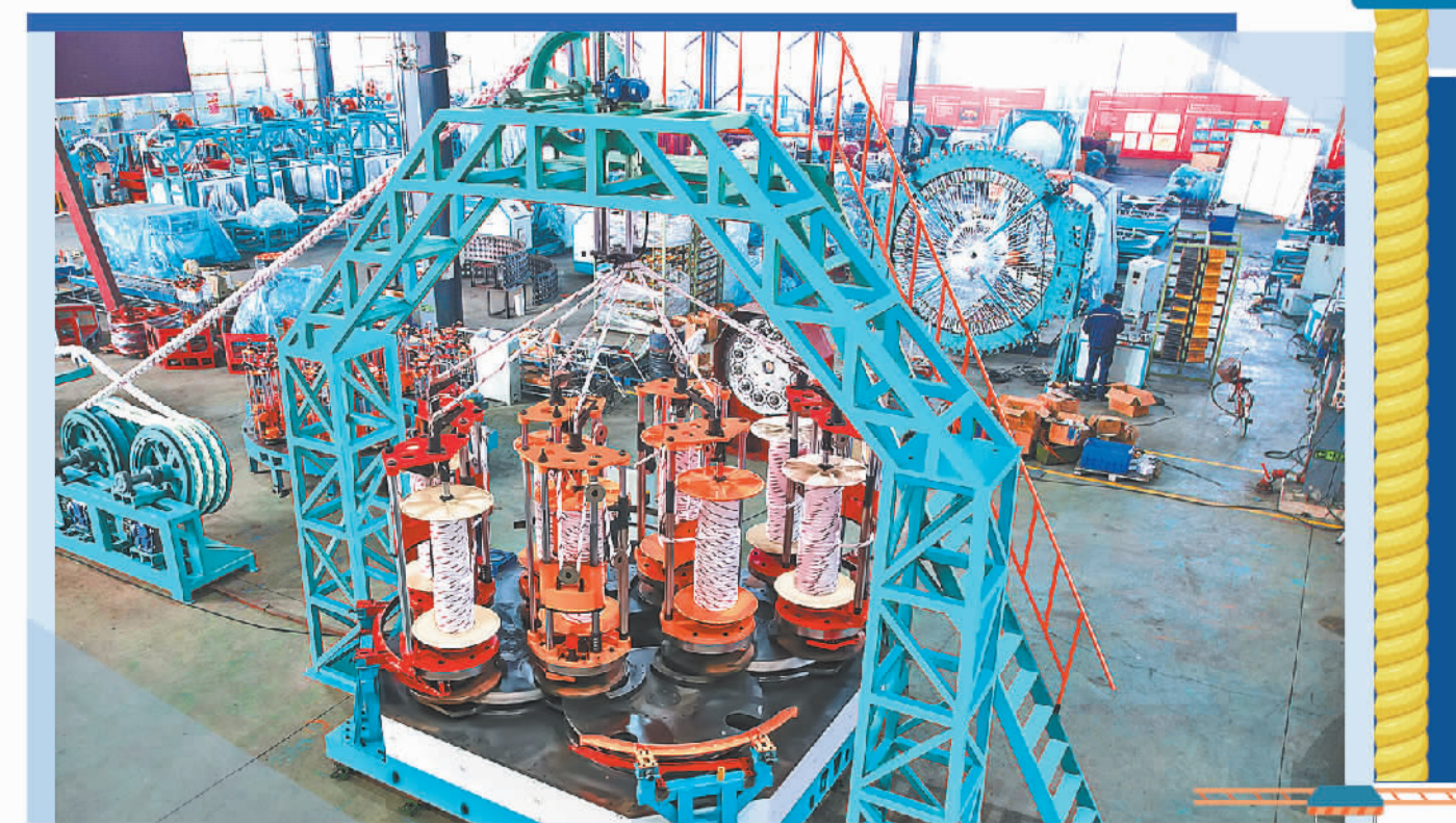
恒辉编织制造的大型重载海工绳编装备。
