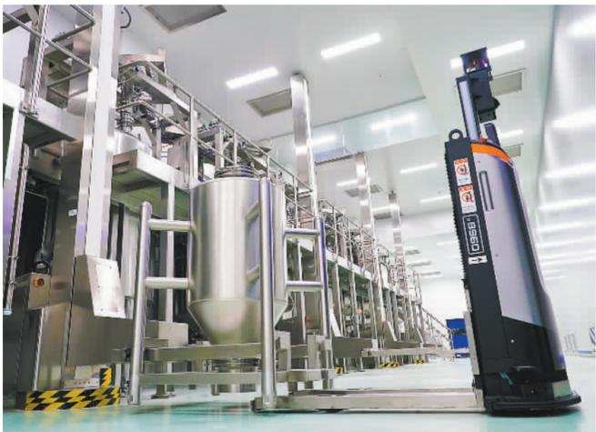
▲11月28日，武汉禾元生物植物源重组人血清白蛋白净化黑灯工厂内，AGV机器人正在工作。
