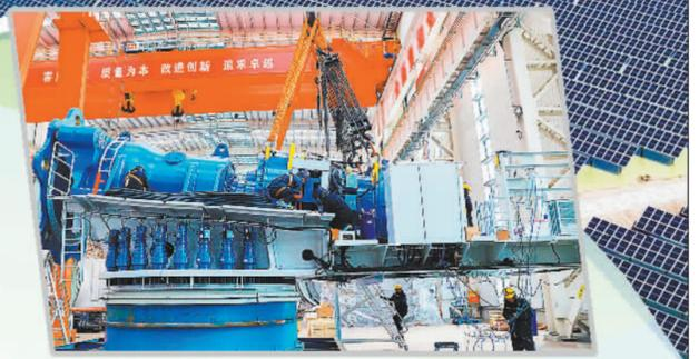
在东营海上风电装备产业园，中船海装年产120万千瓦海上风电机组装备总装基地生产车间内，工人们正在进行海上风电机组的装配
