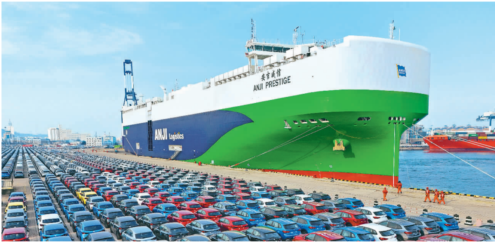
12月25日，一艘7800车位LNG双燃料汽车运输船在山东港口烟台港装车，正式投入运营。该船是目前全球载量最大的LNG动力汽车运输船，进一步提升了“国车自运”能力，为中国车企产能出海赢得更多主动权。
