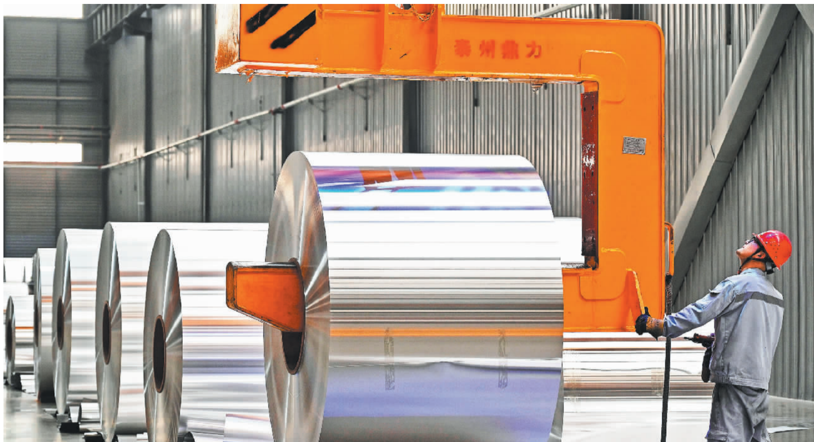
◀2024年12月25日,河南洛阳新星轻合金材料(洛阳)有限公司,工人正在生产锂电池用铝合金箔材。 张光辉摄(中经视觉)
