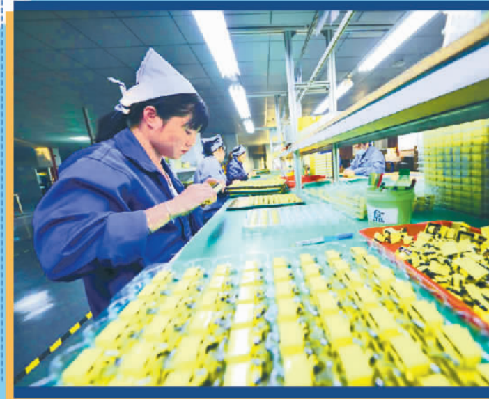
抚州市双菱磁性材料有限公司员工正在安装变压器。 郑莹莹摄(中经视觉)
