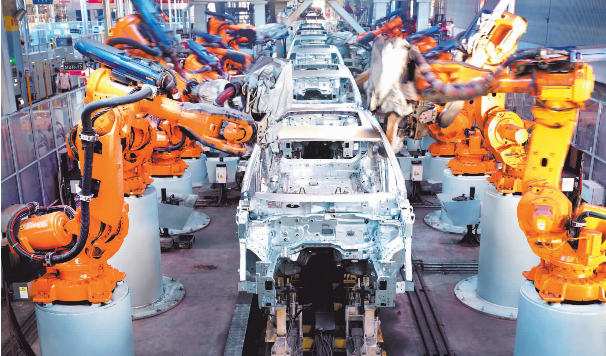
◀2月14日,位于湖南永州市道县高新区的湖南田牧之家农业装备股份有限公司,员工在观察焊接情况。 何红福摄(中经视觉)
