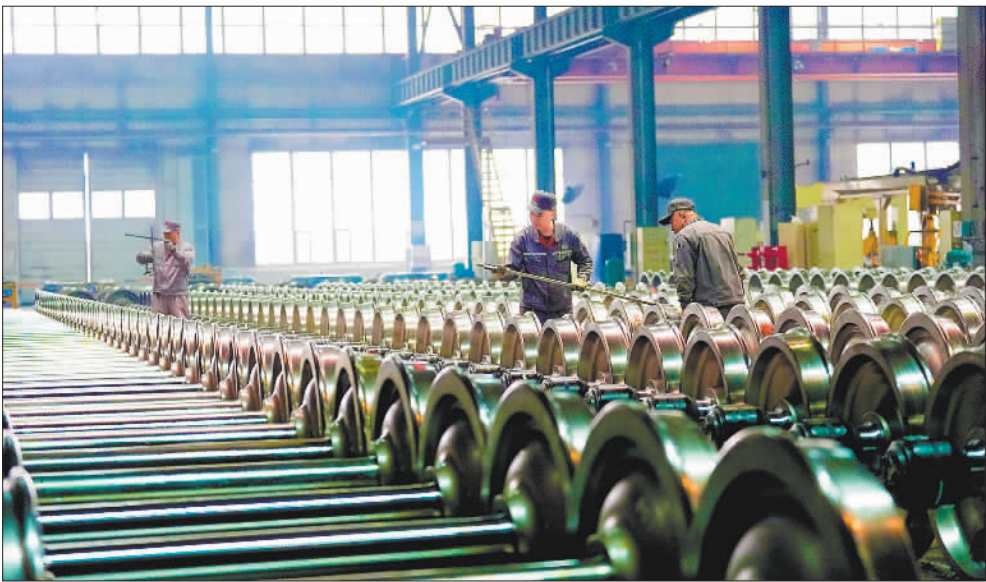
▲2月11日,中车齐齐哈尔车辆有限公司转向架分厂,员工在检测加工完成的轮对。
