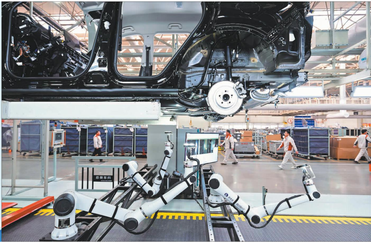
▲2月13日，长城汽车股份有限公司徐水分公司，视觉检测机器人在进行汽车底盘检测。保定通过协同创新和资源整合，与周边地区共同打造智能网联新能源汽车产业集群。
