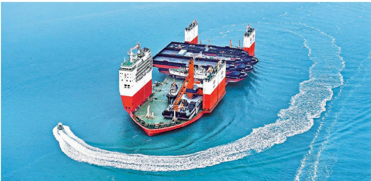
2月26日,新型半潜打捞工程船“华瑞龙”轮,在福建省宁德市三都澳灶屿水域装载13艘工程类船舶,即将出海前往非洲几内亚。“华瑞龙”轮总长252米,型宽60米,型深14.8米,是亚洲第一艘无常规船楼、四岛式设计新型半潜打捞工程船,主要用于大型船舶的应急抢险打捞,兼顾海洋石油和天然气勘探、开采所需大型海上装备、大型船舶的装载和运输。王旺旺摄(中经视觉)
