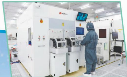
华工科技自主研发的激光退火装备
