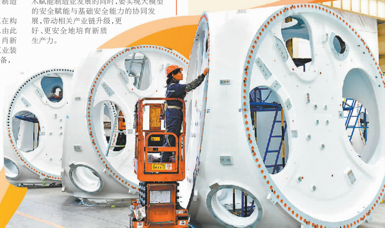
山东省滨州市惠民县风电装备制造产业园涂装车间内，工人在涂装风电轮毂。新华社记者 郭绪雷摄
