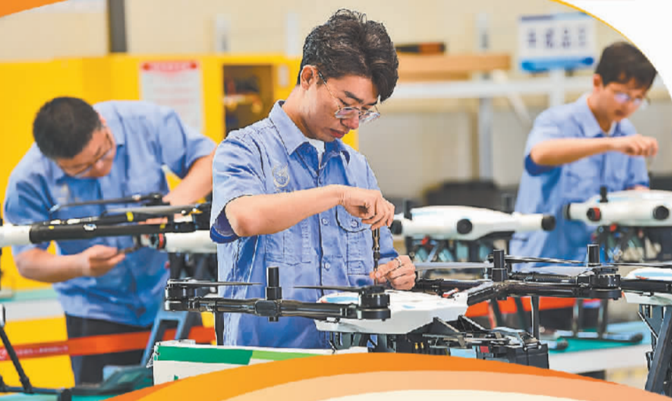
位于江苏省南京市的中航金城无人系统有限公司，工人在生产车间里组装民用多旋翼无人机。 方东旭摄(中经视觉)
