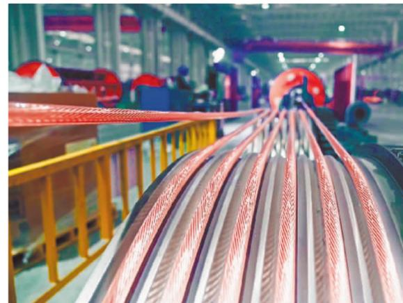
起帆电缆生产车间数根铜线在设备的牵引下紧密绞合，企业抓紧赶制电缆订单
