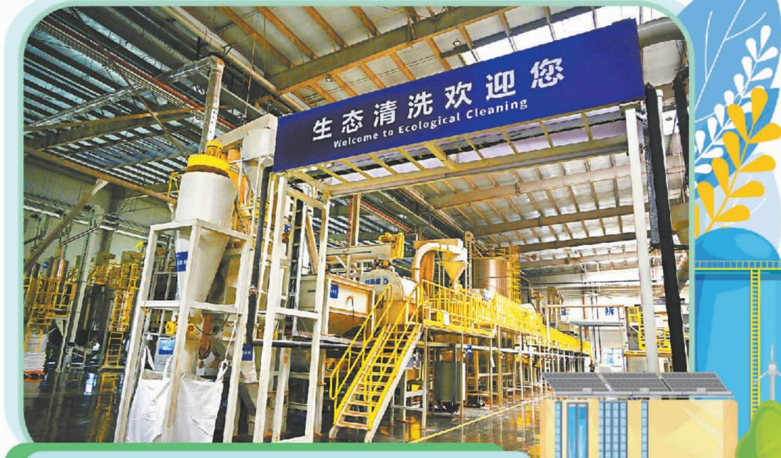
图为海尔绿色再循环互联工厂塑料清洗分选产线。
