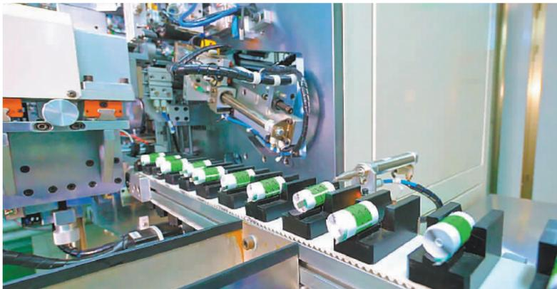
力佳科技高速智能化生产线采用干粉干法工艺,实现了锂锰扣式电池全生产流程的集成,生产效率和品质较传统产线大幅提升。
