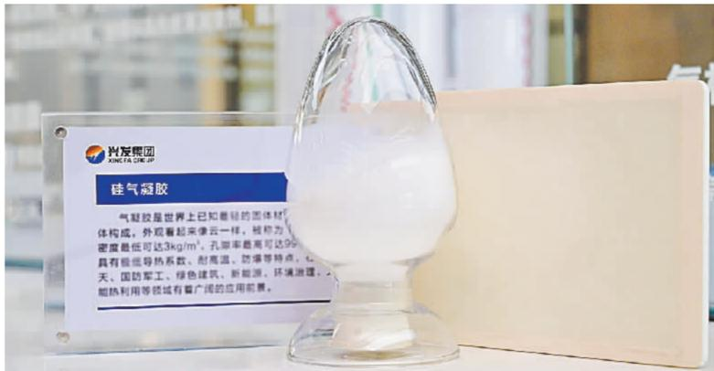
兴瑞硅材料在传统单一硅源气凝胶生产工艺的基础上,开发出多种改性工艺,并创新性地突破了复合硅源生产气凝胶的工艺,产品应用于涂料、纺织、吸油等领域。
