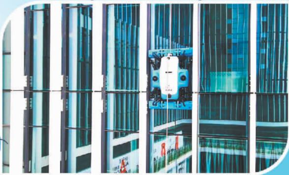
凌度智能公司推出的高空平面幕墙清洁机器人在工作。(资料图片)
