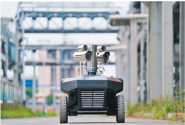
▼2月22日,位于重庆市长寿经开区的重庆长风化学工业有限公司厂区,防爆智能巡检机器人在进行巡检。
