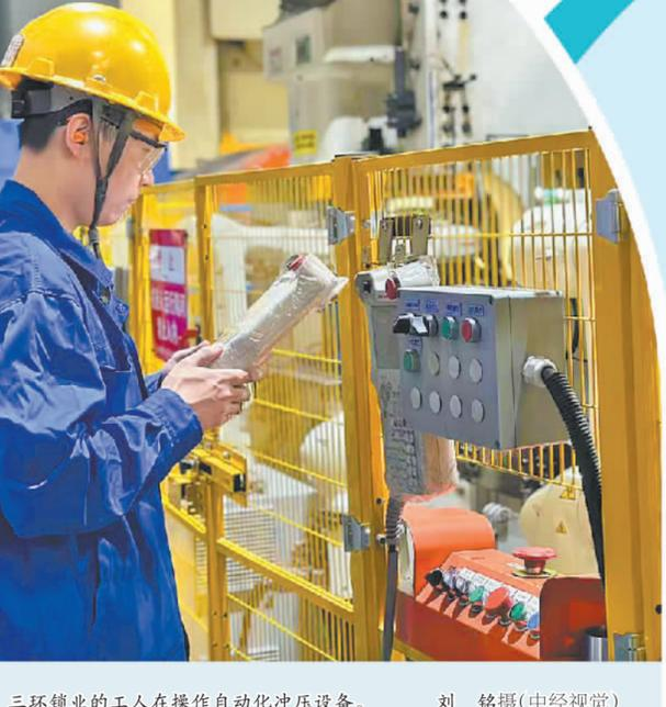
三环锁业的工人在操作自动化冲压设备。
