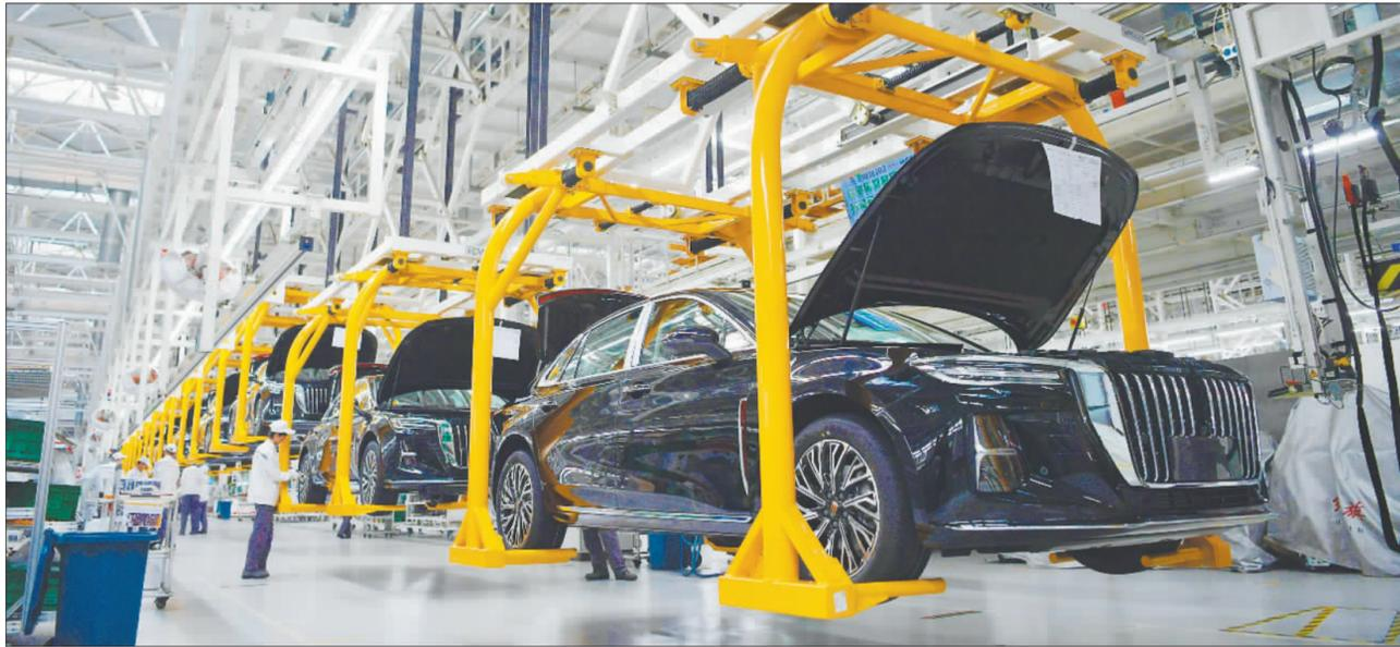
◀中国一汽集团红旗制造中心繁荣厂区总装车间生产线。这里共有14条自动化生产线，1分钟下线1台车(摄于2024年12月26日)。
