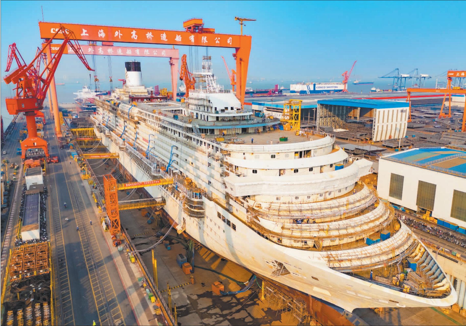
▲3月26日，中船集团上海外高桥造船有限公司，国产大型邮轮全船进入设备、系统调试和内装工程阶段。
