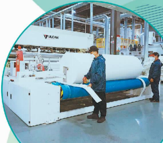
位于诸暨市陶朱街道的恒肯中智新材料有限公司制毡车间内，工人在生产碳纤维高温热场材料。方成摄
