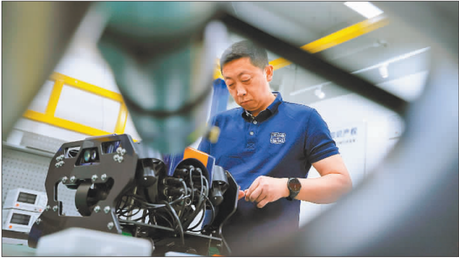
▲4月23日,博雅工道(北京)机器人科技有限公司水下智能装备体验中心,工程师在安装调试水下检修专用机器人系统。
