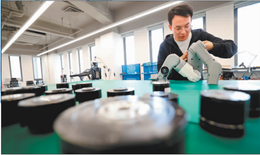
▲4月23日,北京灵足时代科技有限公司实验室,工程师在为机器人安装一体化关节模组。该公司研发的核心零部件已在多个行业实现批量交付。
