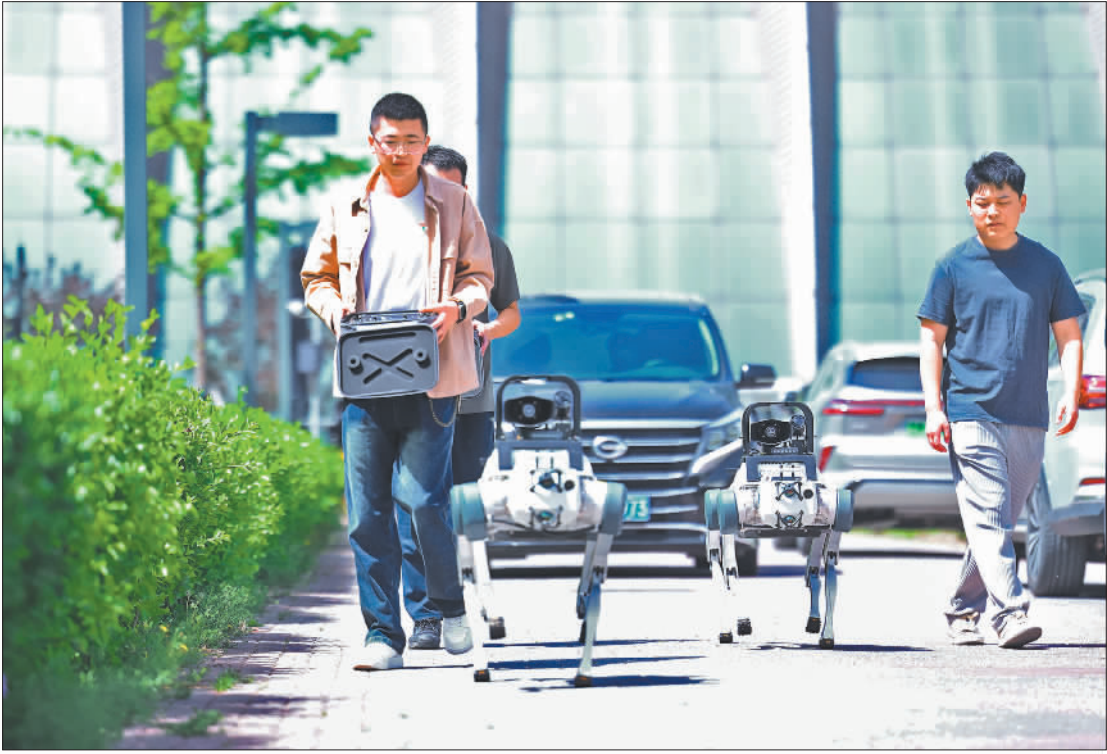
▲4月23日,技术人员在北京亦庄博大大厦南侧花园对机器巡逻犬进行测试。机器巡逻犬可搭载多种装备,执行巡逻、环境监测等任务,通过5G网络与智慧城市系统连接,实现信息共享和任务接力。
