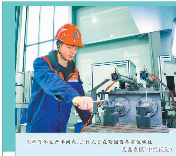
同辉气体生产车间内，工作人员在紧固设备定位螺丝。
