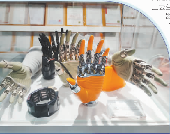
上海傲意信息科技有限公司研发的机器人灵巧手。 本报记者 王明昊摄
