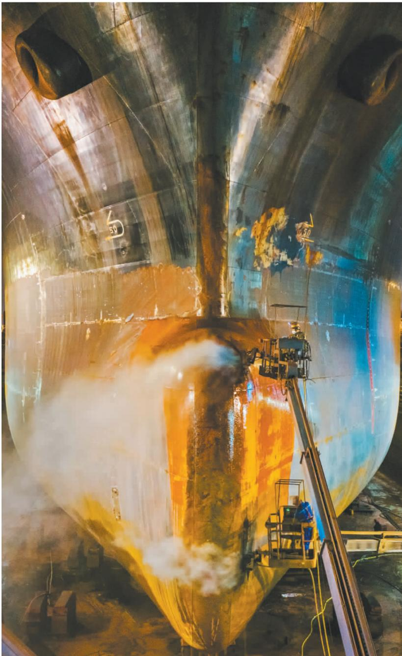
▲5月1日,位于广州市黄埔区的广东中远海运重工有限公司,工人对船舶进行除锈、除漆、清洗作业。邱新生摄(中经视觉)
