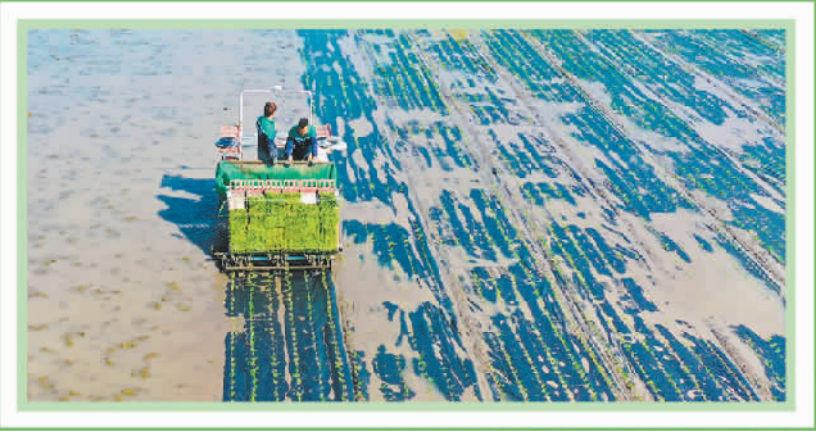
▲5月18日,黑龙江双鸭山市友谊县农业科技园区,水稻覆膜插秧一体机在插秧作业,该机器可同时完成打孔、覆膜和插秧。 徐宏宇摄(中经视觉)
