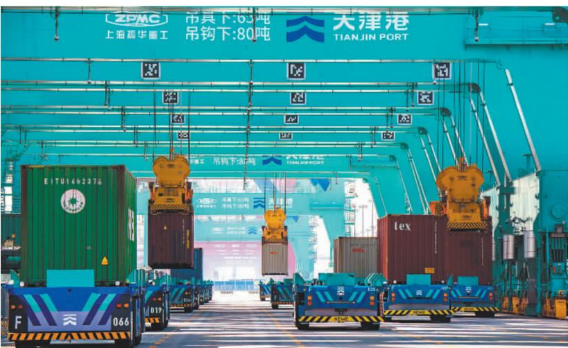
▲4月26日,天津港第二集装箱码头,L4级人工智能运输机器人在自主有序进行集装箱运输作业。
