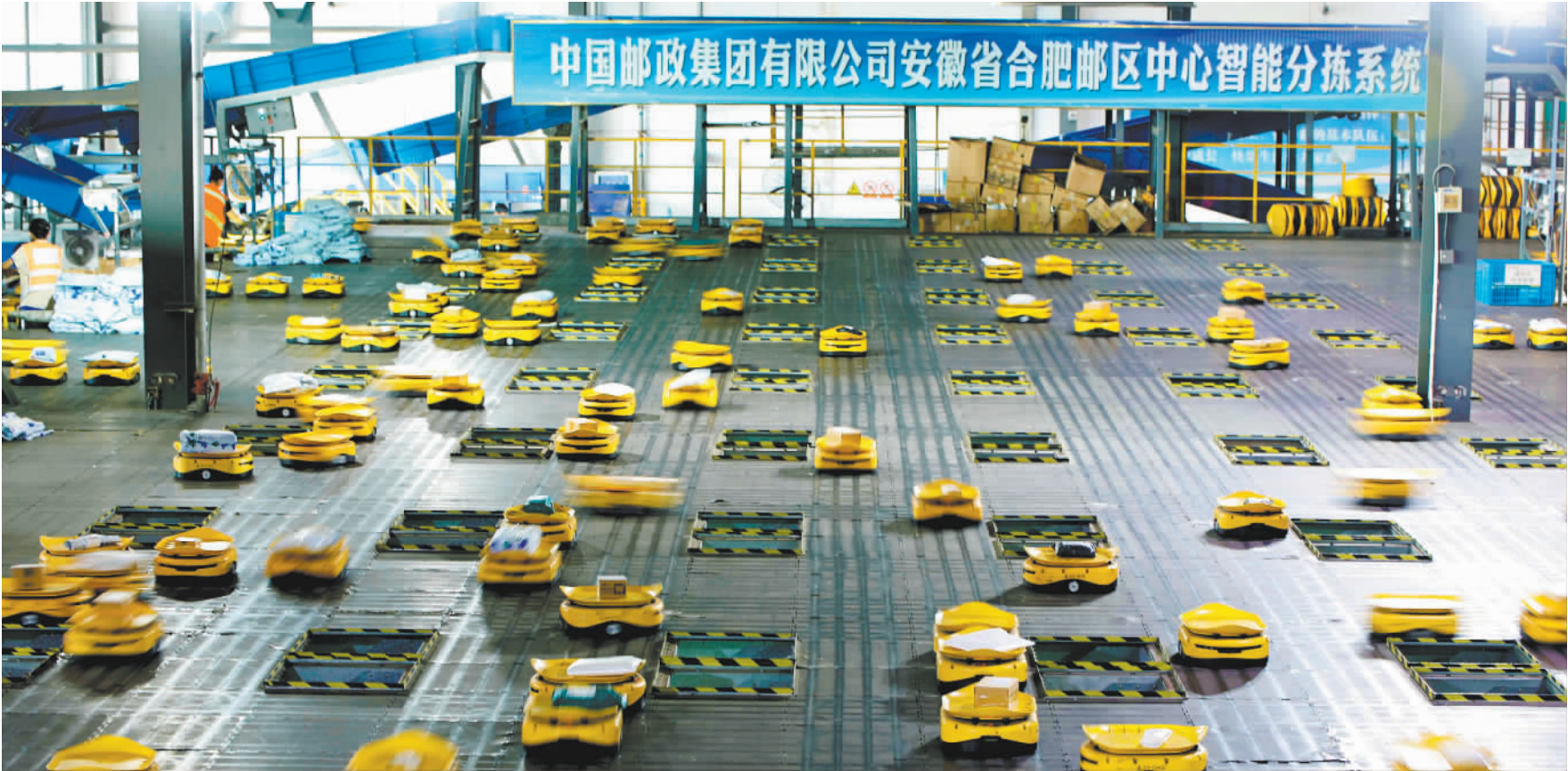
▼6月16日,安徽省合肥市新站高新区中国邮政合肥邮区中心,200余台智能分拣机器人在作业平台上进行精准分拣。 张 敏摄(中经视觉)
