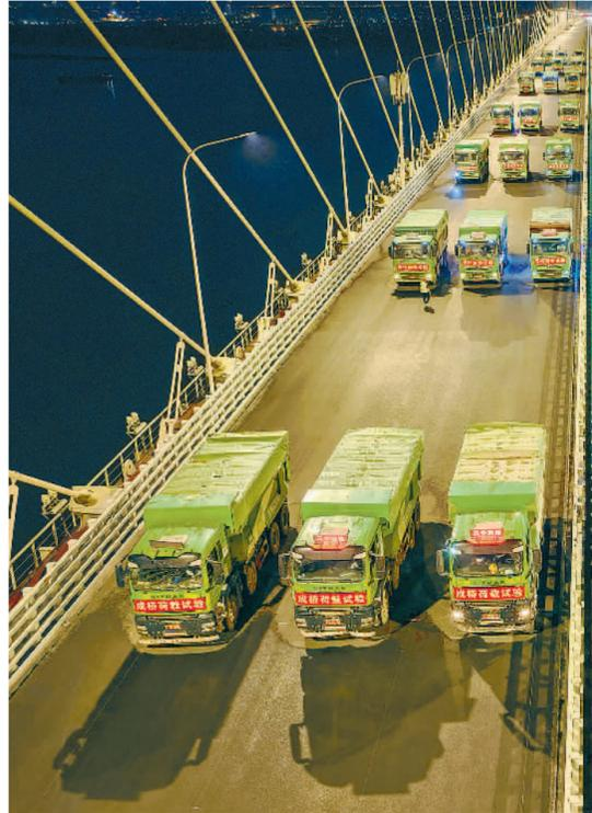
6月20日,江苏省常泰长江大桥开展主跨斜拉桥荷载试验。110辆重型卡车在主跨斜拉桥上加载,最高加载总重量达4400吨。
