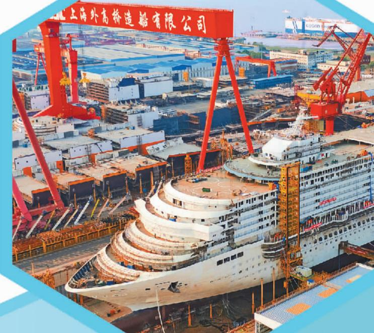
在中船集团上海外高桥造船有限公司，国产大型邮轮二号船全船贯通后进入设备、系统调试和内蒙工程阶段。本报记者 赵晶摄
