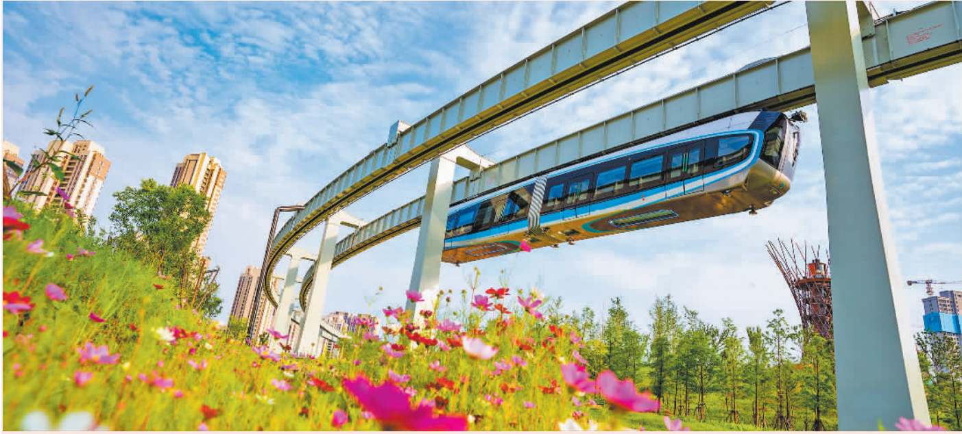
▲武汉光谷空轨在空中穿梭。作为国内首条悬挂式单轨系统，光谷空轨采用全自动无人驾驶模式，相比于传统列控方式可节约能耗近20%(摄于2023年5月9日)。
