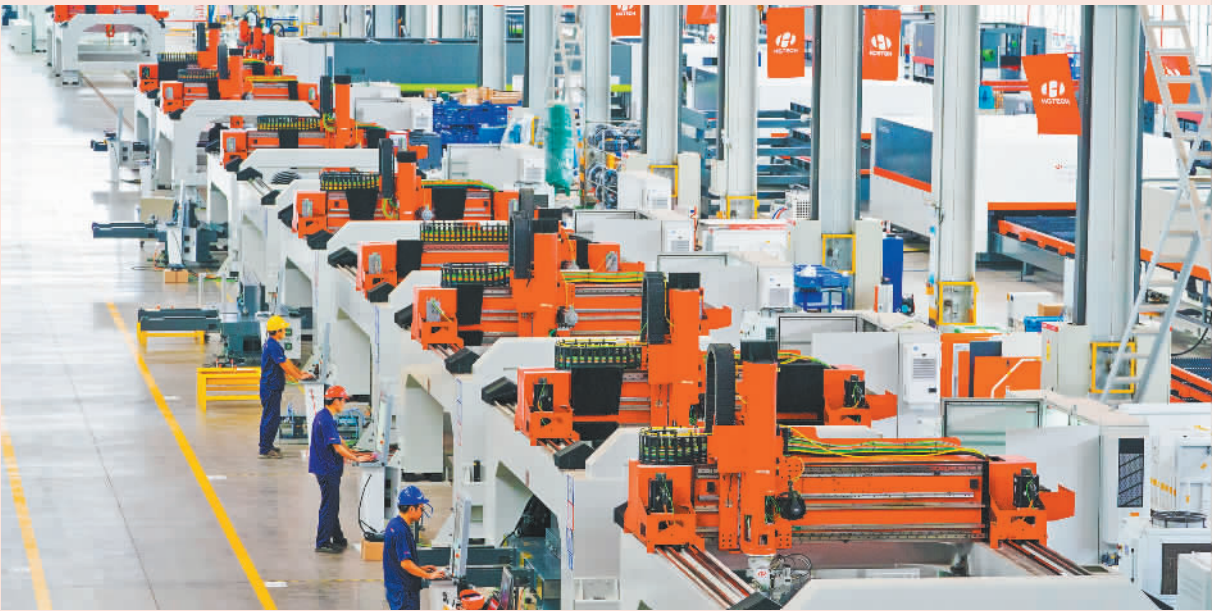
▼位于武汉新城的华工科技智能装备产业园葛店园区，工作人员在国内最大的三维五轴激光切割机产线上组装、调试订单设备(摄于2023年6月6日)。
