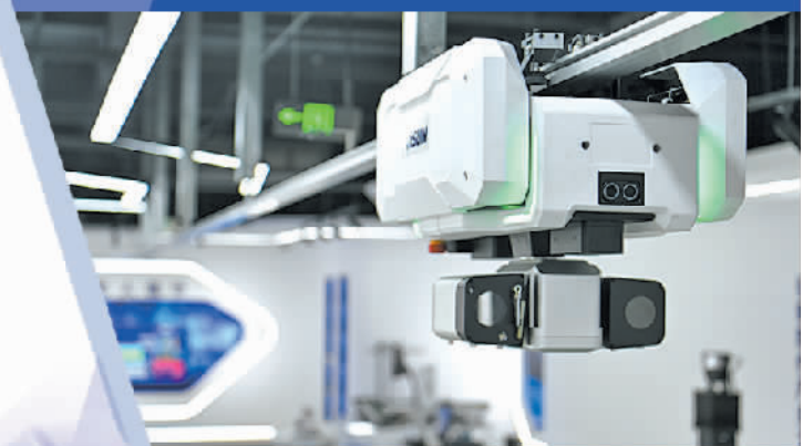
图为位于京津冀中关村科技新城的天津新松智能科技股份有限公司的轨道式无人值守机器人。
