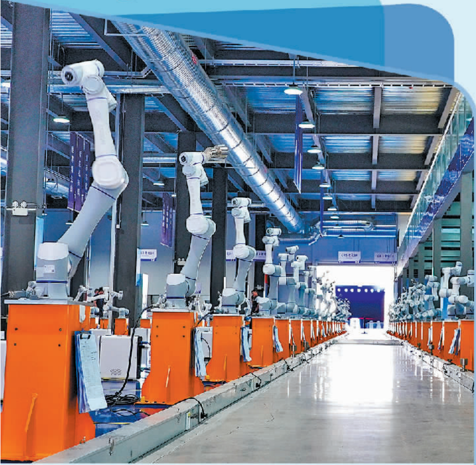
越疆科技日照生产基地内，机械臂在进行出厂测试。
