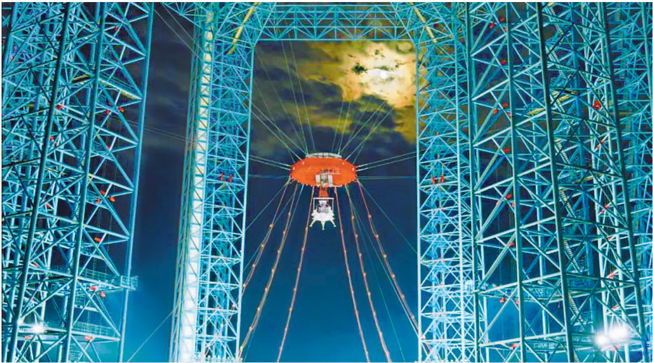
8月6日,揽月月面着陆器着陆起飞综合验证试验在位于河北省怀来县的地外天体着陆试验场圆满完成,标志着我国载人月球探测工程研制工作取得新突破。这是揽月月面着陆器在地外天体着陆试验场进行测试。(中国载人航天办公室供图)
