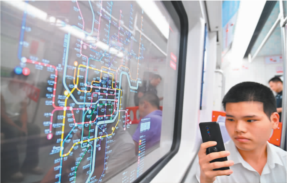
▲5月7日,重庆轨道交通1号线列车智慧车窗,乘客在透明OLED显示屏上查看线路、前方到站、3D站台、周边景点等信息。重庆市已打造多个智慧车站,采用智慧安防、智能开关站、客流智能分析预测等技术,为乘客带来全新的出行体验。 孙凯芳摄(中经视觉)
