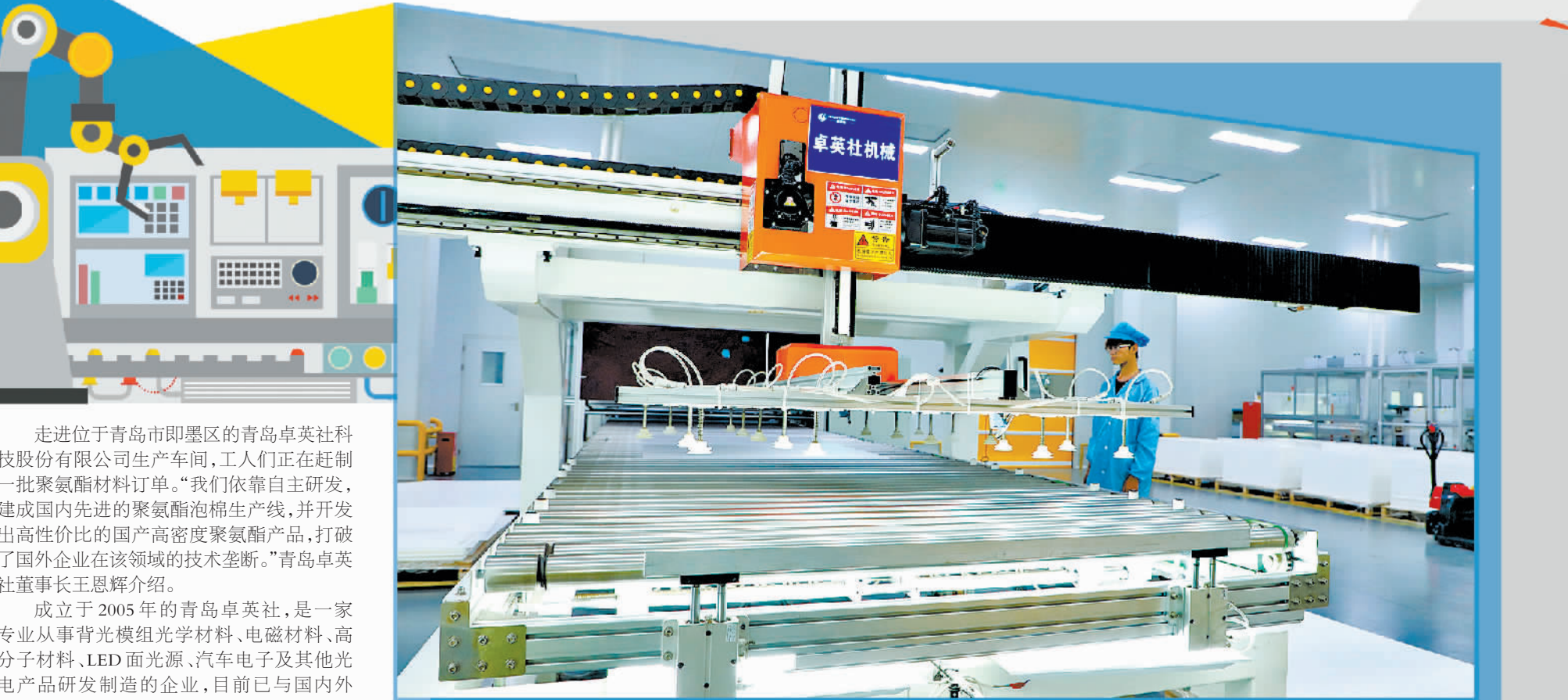
青岛卓英社生产车间内,工人对显示器背光模组用发泡扩散板进行检测。
