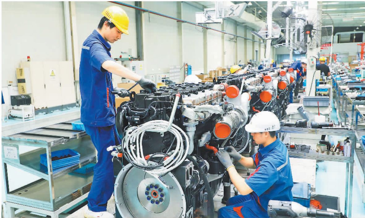
位于安徽芜湖三山经济开发区的玉柴联合动力股份有限公司内,工人在天然气发动机生产线上作业。近年来,公司积极推进绿色工厂建设,打造具有核心竞争力的动力系统产品,销往多个国家和地区。 程依子摄(中经视觉)
