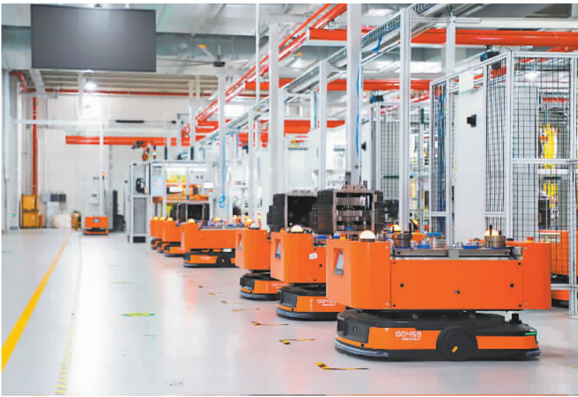
▼7月21日,位于金山区的特百佳动力科技股份有限公司芯工厂内,AGV自动搬运车排列整齐。该公司自动变速箱产线全线采用AGV无人化运输。
