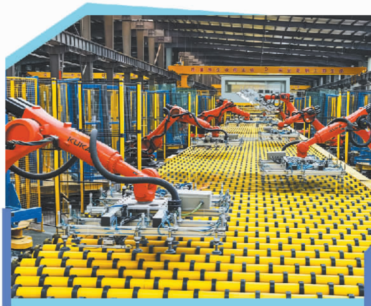
中联玻璃的智能工厂内,机械臂在抓取玻璃。
