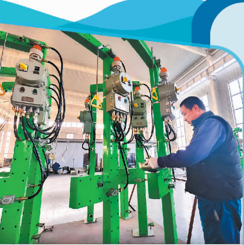
河北润旺达车间内,工作人员在组装应急冲淋洗眼设备。
