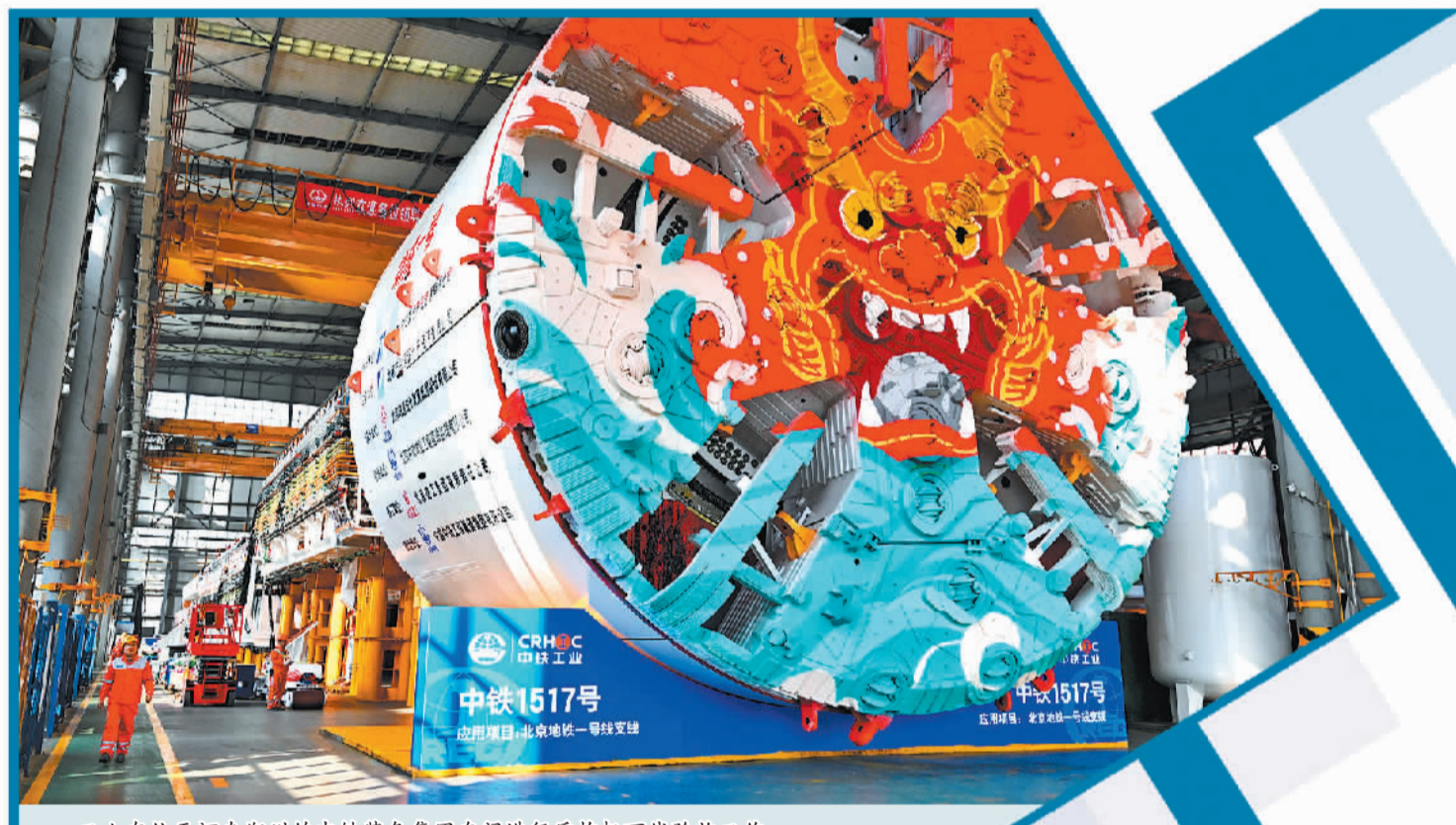
工人在位于河南郑州的中铁装备集团车间进行盾构机下线验收工作。
