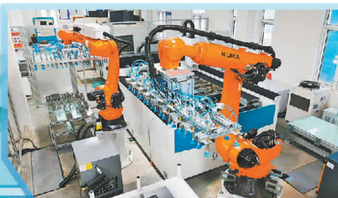
柳钢集团智能化全自动钢铁分析检测线。(资料图片)
