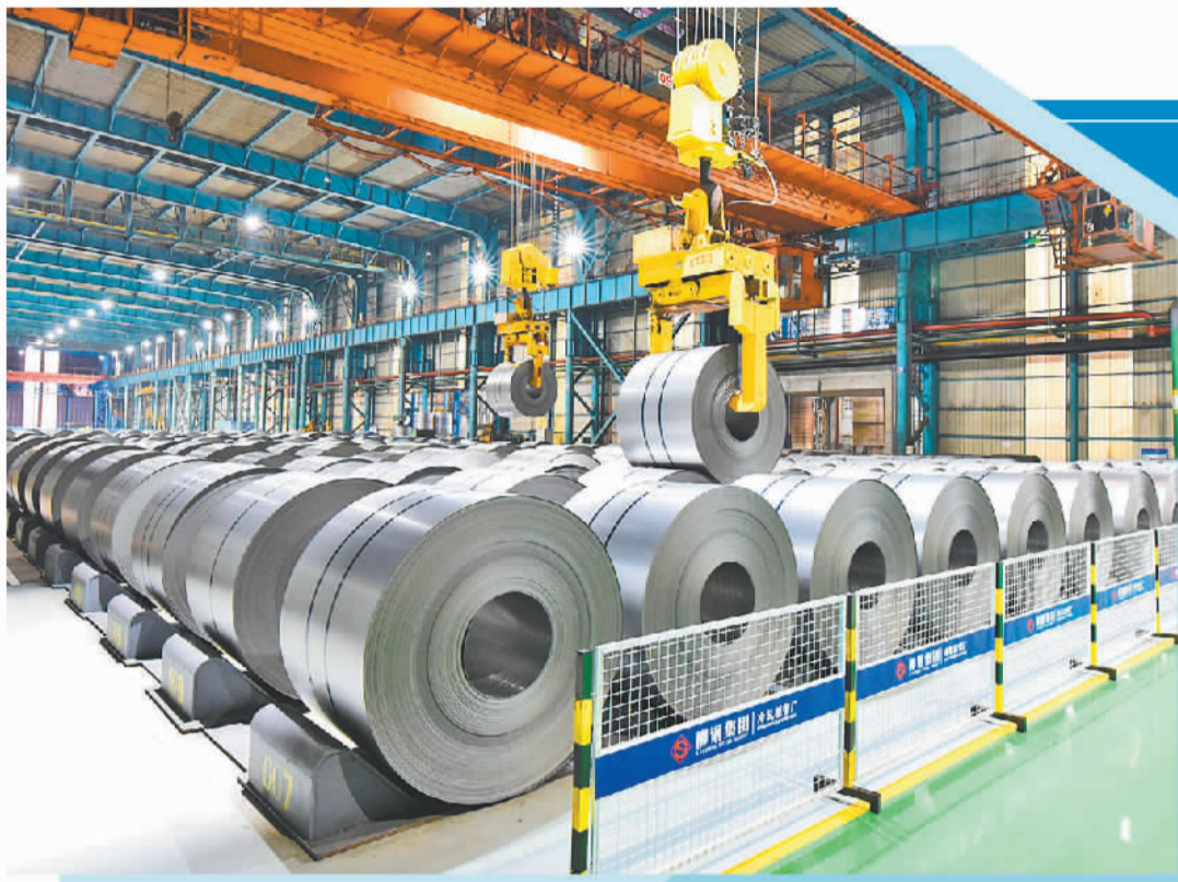
柳钢集团冷轧厂内,无人天车在吊运钢材。(资料图片)
